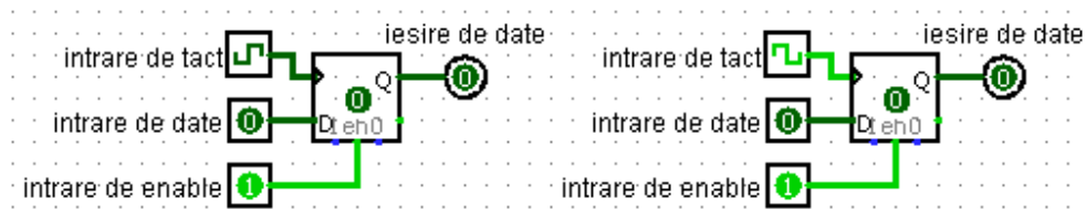
Figura 5 – Intrarea de enable este 1 (circuitul funcționează), intrarea de date este 0, intrarea de tact trece din 0 în 1 și circuitul va memora 0.
