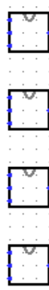
Figura 13 – Instanțierea a 4 module simple mux_2la1_1bit, în modulul main, pentru a crea un multiplexor 2 la 1 pe 4 biți.
