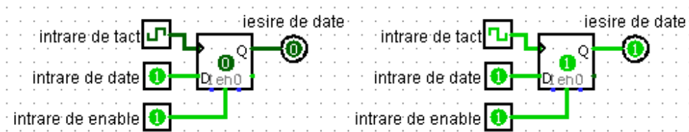
Figura 6 – Intrarea de enable este 1 (circuitul funcționează), intrarea de date este 1, intrarea de tact trece din 0 în 1 și circuitul va memora 1.
